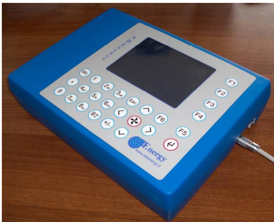
FIG. 2.5 Apparecchio portatile per l'analisi del biogas
