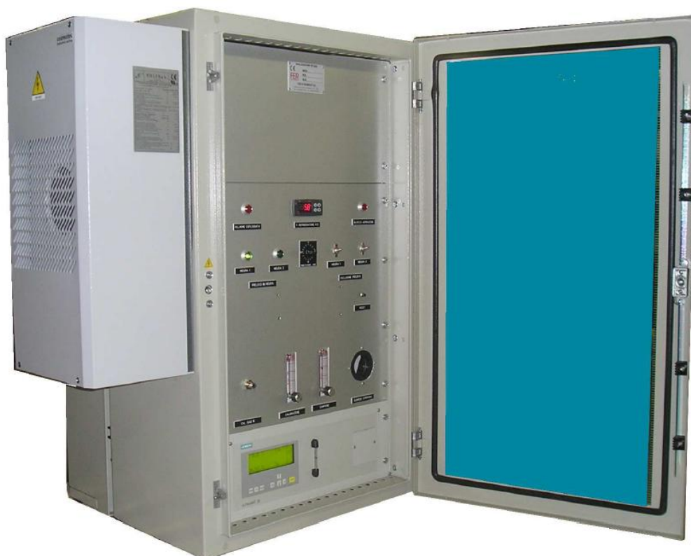
FIG. 2.4 Apparecchiatura di processo per l'analisi in continuo del biogas
